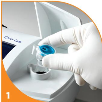
1 Scannez le code-barres d'étalonnage du lot. Retirez le sachet de la cartouche, puis insérez ce dernier dans l'analyseur.
